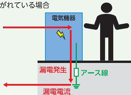
漏電を監視している漏電ブレーカーが設置されている場合でも、正常に動作するためにはアース線が重要な役目を果たしています。
